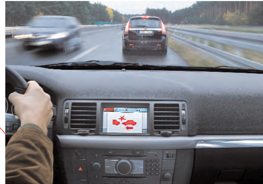
| Kollisionsgefahr: Das Display signalisiert einen drohenden Auffahrunfall. Ein Ton und Vibrationen am vorderen Teil des Sitzes unterstützen die Warnung
